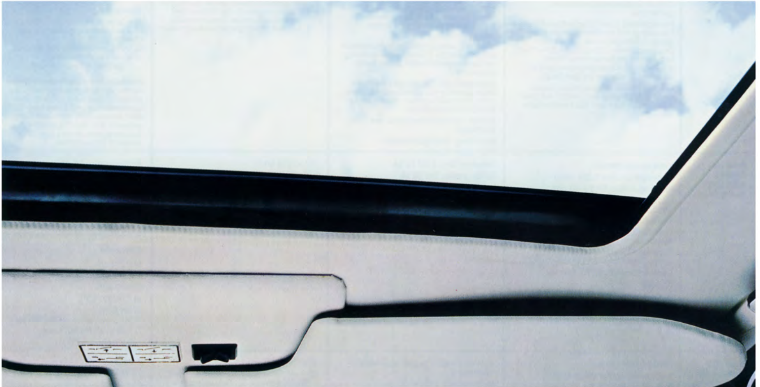
Das Schiebe-/Ausstelldach (hier mit elektrischer Betätigung).
