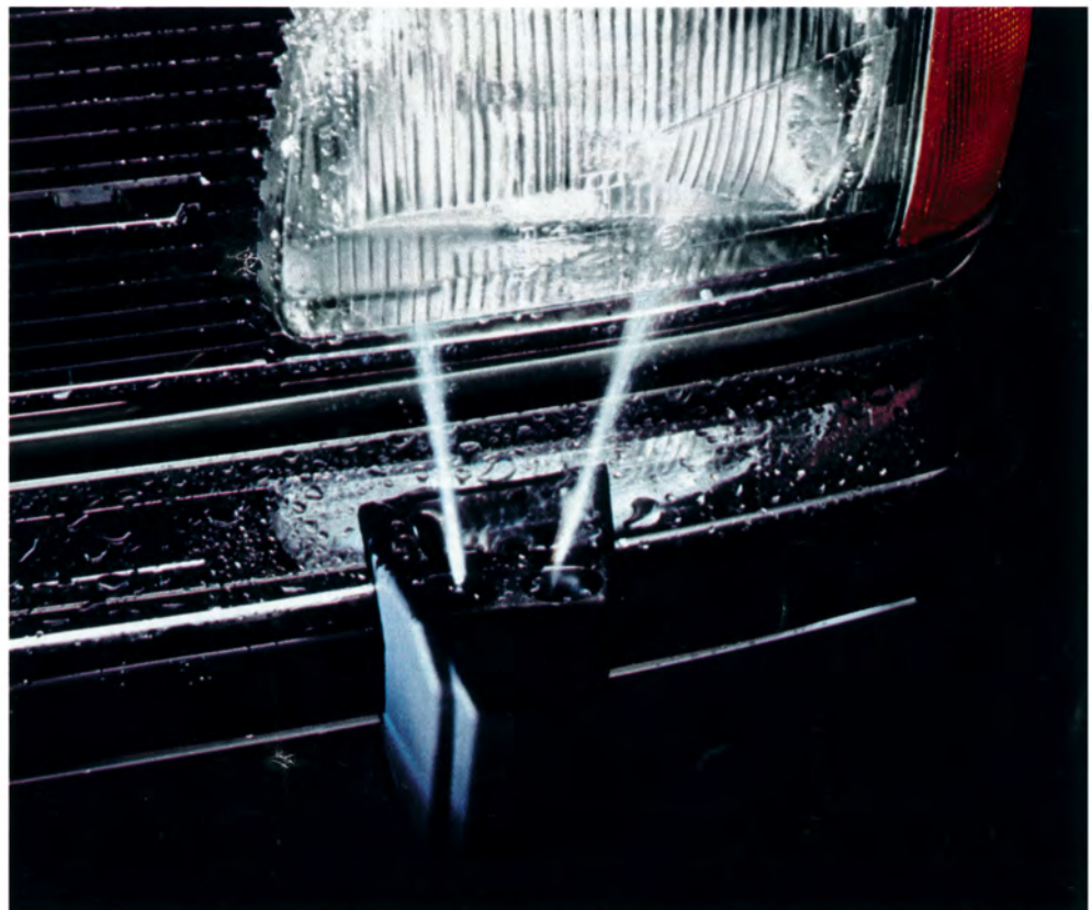
Die Scheinwerfer-Reinigungsanlage sorgt für saubere Scheinwerfergläser und damit für sicheres Licht. Denn schon eine geringe Verschmutzung der Scheinwerfer kann die Lichtwirkung stark herabsetzen.
