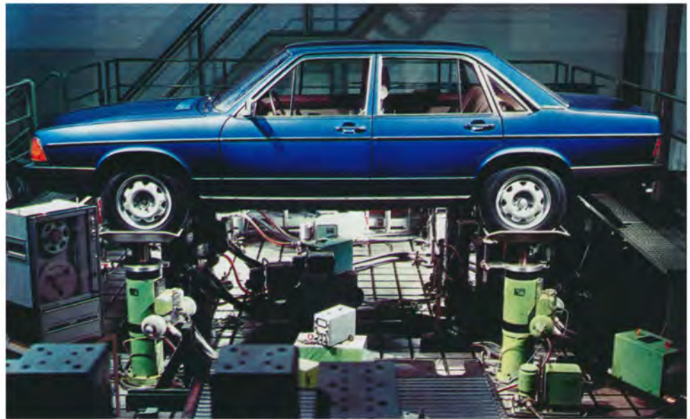
Die Tests auf dem Rüttelstand entsprechen einer Fahrstrecke von insgesamt 850.000 Kilometern.
