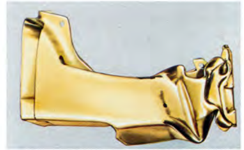
Audi 100-Längsträger: Dieser Träger beginnt sich bei einem Aufprall immer von vorn nach hinten zu falten.
