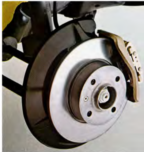
Vorn hat der Audi 50 große Schwimmsattel-Scheibenbremsen.
