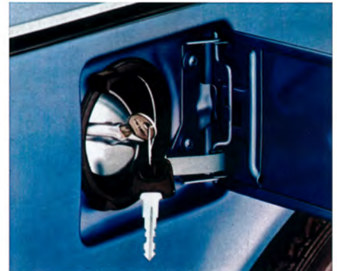
Der abschließbare Tankverschluß. Er bietet Ihnen viel Sicherheit vor unbefugtem Öffnen.
