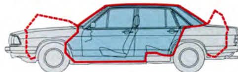
Die Sicherheits-Passagierzelle wird vorn und hinten von computerberechneten Knautschzonen geschützt.
