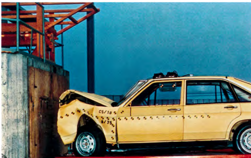
Im Frontal-Aufprallversuch zeigt die Sicherheits-Karosserie, daß sie sehr viel Schutz bieten kann.
