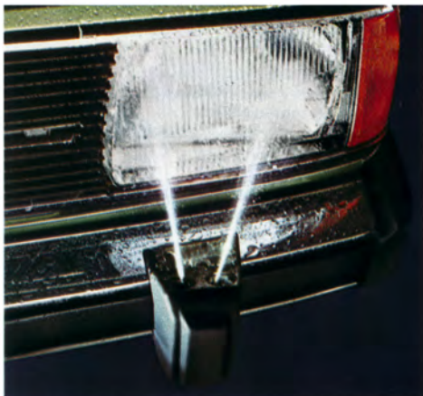
Die Scheinwerfer-Reinigungsanlage für saubere Scheinwerfergläser und sicheres Licht.
