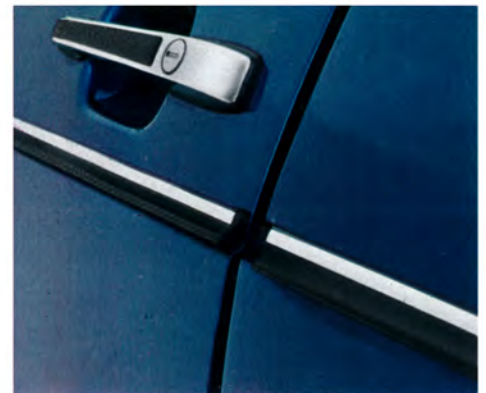
Die Zierleisten an der Gürtellinie des Wagens sind mit einem elastischen Profil versehen, das den Lack vor kleineren Parkschäden schützt.
