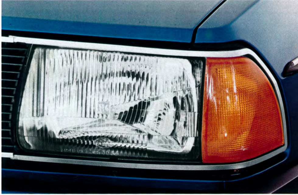
Die H4-Halogencheinwerfer lassen sich ohne Werkzeug auf größte Leuchtweite ohne Blendwirkung einstellen. Wichtig, wenn der Wagen hinten stark beladen ist.
