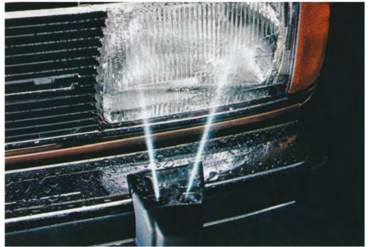
Die Scheinwerfer-Reinigungsanlage gibt immer sicheres Licht.
