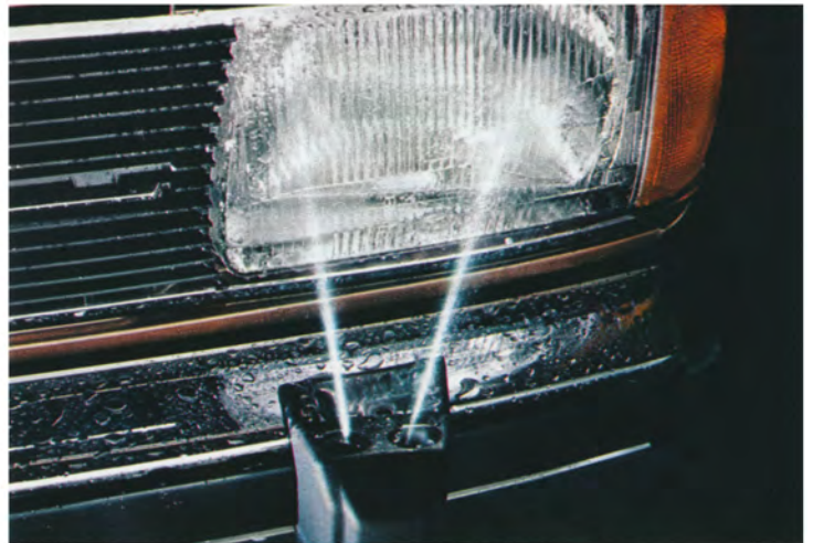
Die Scheinwerfer-Reinigungsanlage gibt immer sicheres Licht.
