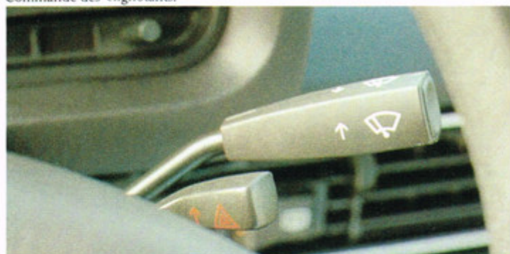
Manette de commande de l'essuie-glace à 3 vitesses et lave-glace électrique 4 jets.
