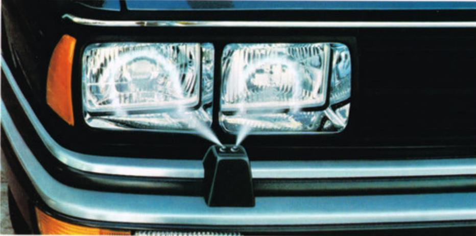
Scheinwerfer-Reinigungsanlage für sichere Sicht.
