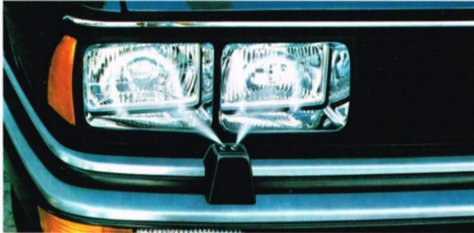
Scheinwerfer-Reinigungsanlage für sichere Sicht.
