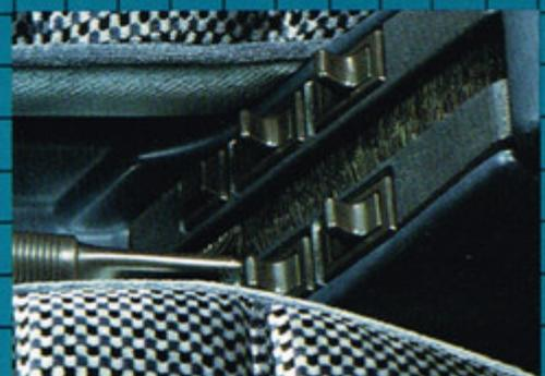
Commandes des vitres électriques et du verrouillage des portières sur le bloc central.
