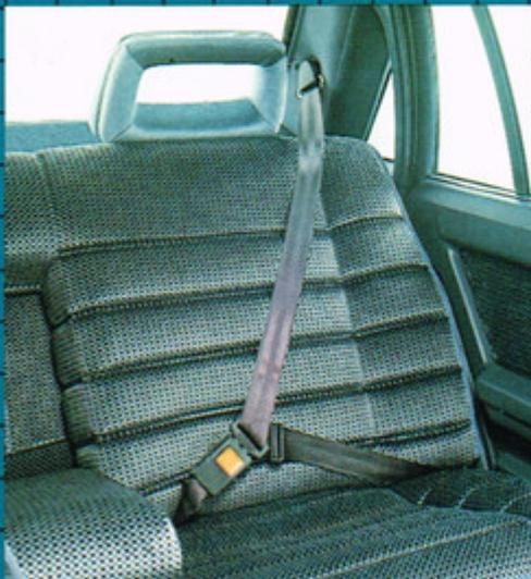
Ceintures de sécurité trois points, à l'arrière, et une ceinture ventrale au centre à l'arrière.
