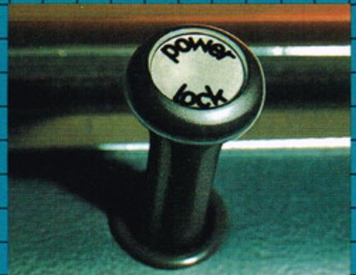
Système de verrouillage des portières et du coffre à commande centrale électrique.
