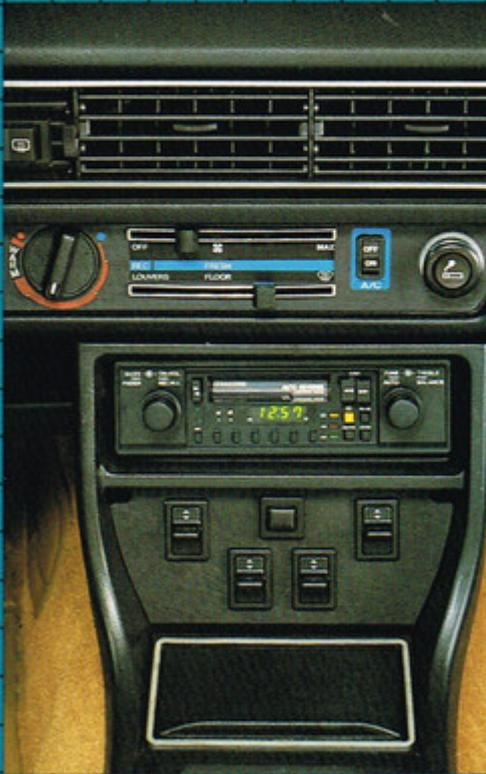
Commandes du climatiseur. Lecteur de cassettes AM/FM stéréo avec affichage numérique de l'heure et de la fréquence et syntonisation électronique. Vitres électriques et commandes de verrouillage des portières
