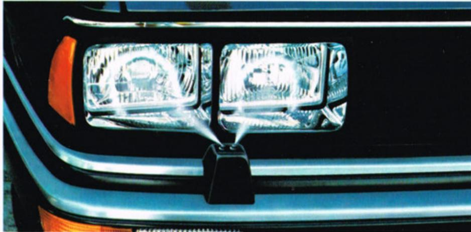
Scheinwerfer-Reinigungsanlage für sichere Sicht.
