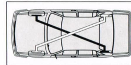
*Beim Diagonal-Zweikreis-Bremssystem bleibt auch bei Ausfall eines Bremskreises die Bremskraftverteilung zwischen Vorder- und Hinterachse unverändert. An beiden Achsen verbleibt eine Bremswirkung von 50%.*
