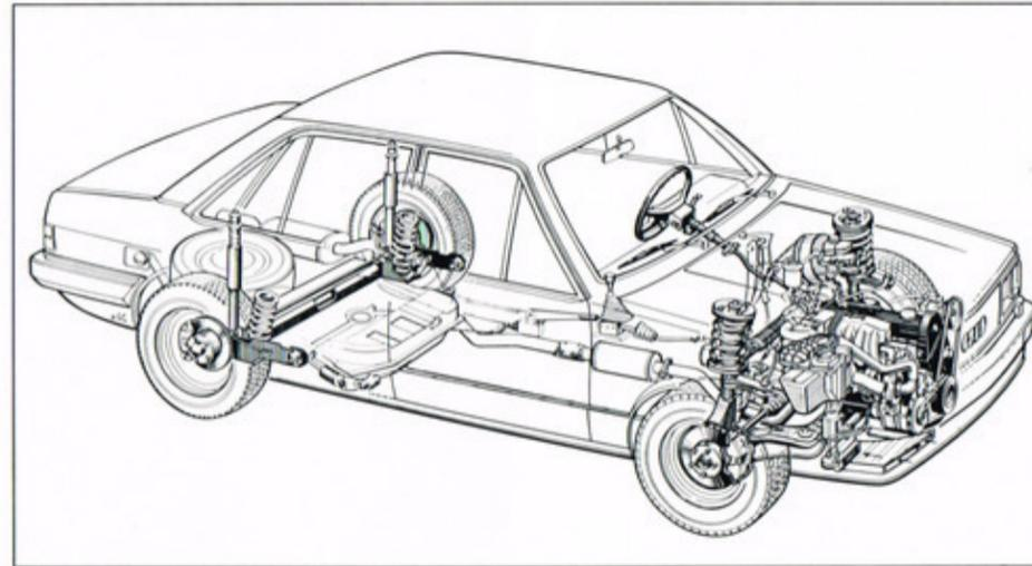
*Das Audi 200-Fahrwerk. Mit langem Radstand, breiter Spur und Scheibenbremsen vorn und hinten. Mit Federbeinen vorn und Torsionskurbelhinterachse. Mit Frontantrieb und sehr guter Abstimmung von Dämpfung und Federung.*
