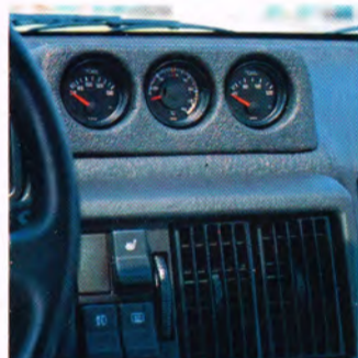
Instrumenten-Konsole. 443 054 180 3BY Zur Aufnahme von 3 Zusatzinstrumenten mit 52 mm Durchmesser.
