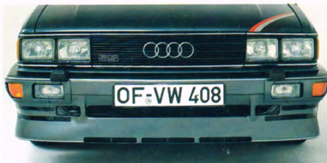
Frontstoßstangenspoiler. 811 071 609 Aus dem Aerodynamik-Anbausatz. Auch in Verbindung mit Seitenschwellern rechts und links zum Anbau zugelassen.
