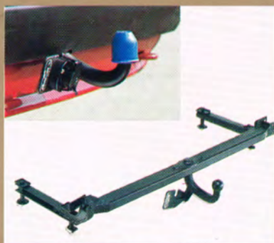
Anhängervorrichtung. 443 092 101 für Audi 100 ab 8/82. Für Fahrzeuge mit Niveau-Ausgleich 443 092 160. Zul. Anhängelast 2 t. Anhängervorrichtungen sind für alle Audi-Modelle lieferbar.
