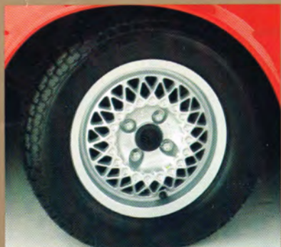
Speichendesign. Für Audi 80 bis 7/78 5,5x13" mit 185/70 HR 13 185 071 555 B Für Audi 80 und Audi Coupé, außer GT 5E (130 PSI) 5,5x13" mit 175/70 HR 13 175 071 555 B.
