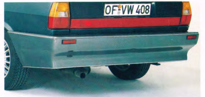
Heckstoßstangenspoiler. 855 071 610 Aus dem Aerodynamik-Anbausatz. Nur in Verbindung mit Frontstoßstangenspoiler und Seitenschwellern rechts und links zum Anbau zugelassen.
