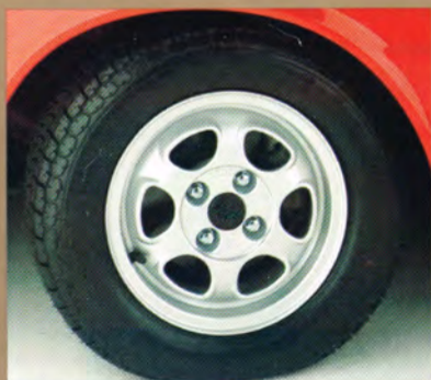
Lochdesign. Für Audi 80 ab 8/76-7/78 5,5x13" mit 185/70 HR 13 185 071 555 Für Audi 80 ab 8/76 5,5x13" mit 175/70 HR 13 175 071 555.
