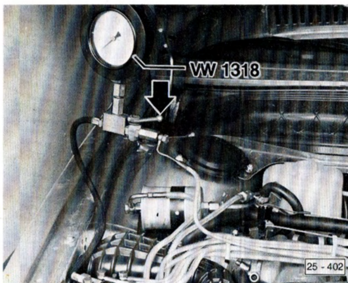
Abb. 2 Druckmeßvorrichtung-Ventil in Stellung offen.
