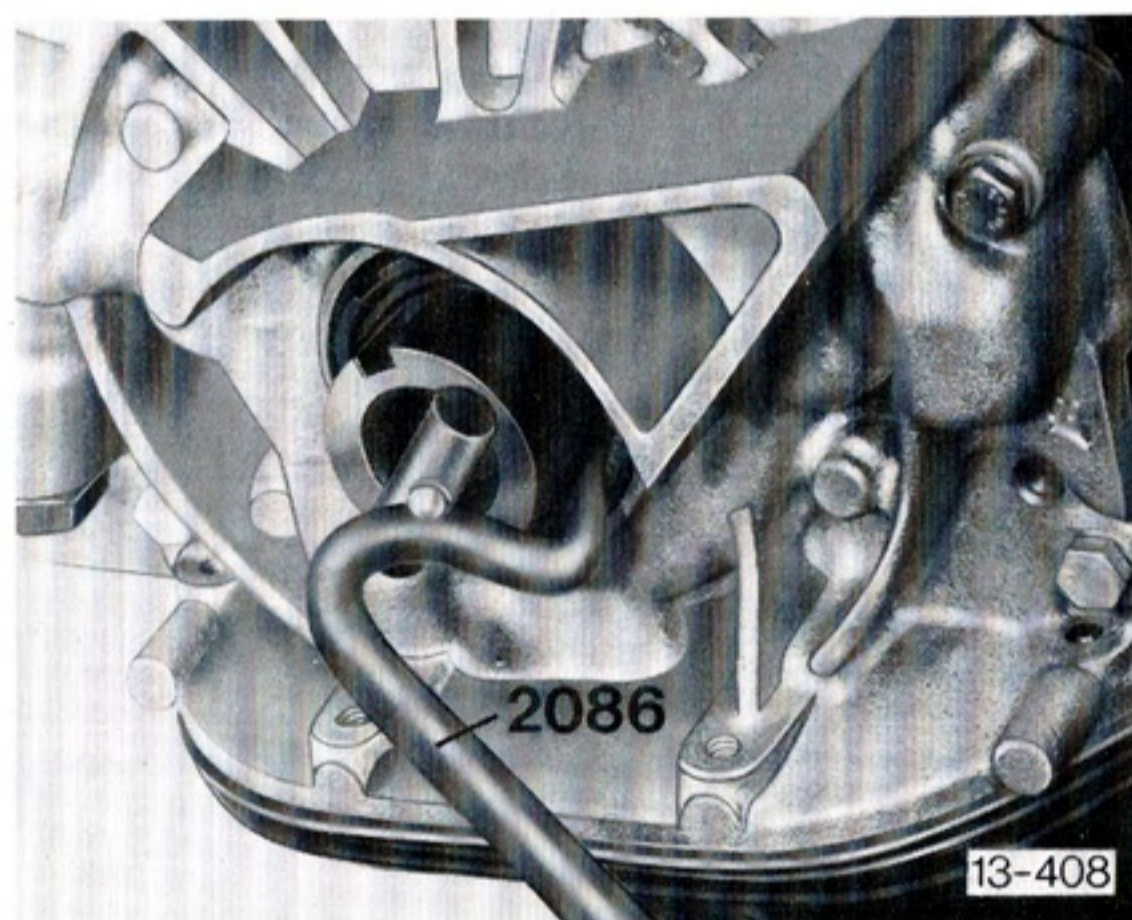
Abb. 7 Dichtring Kurbelwelle Riemenscheiben- seite ausdrücken
