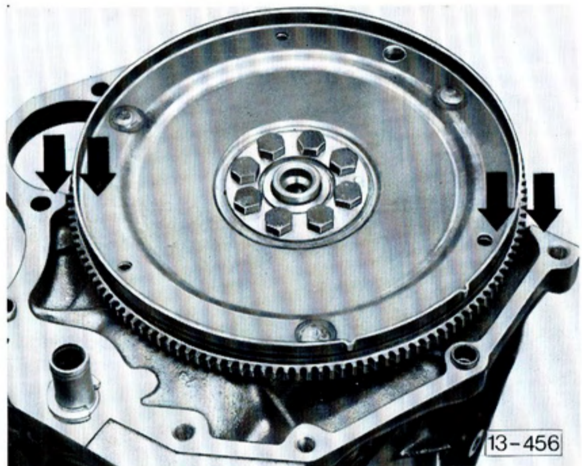
Abb. 5 Mitnehmerscheibe an 2 Stellen zum Motorblock ausmessen.
