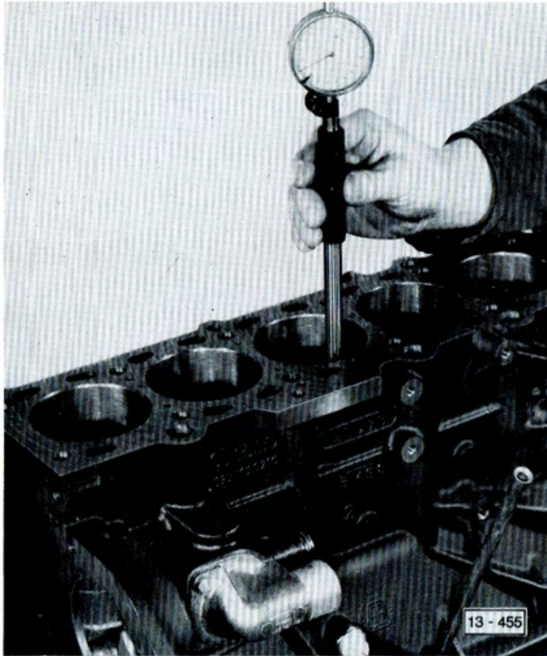
Abb. 13 Zylinderbohrung messen – Mit Innenfeinmeßgerät messen.
