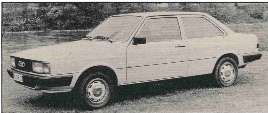
Extreme im Audi-Programm: 80 L mit 1,3 Liter-Motor und 40 kW (55 PS)...
