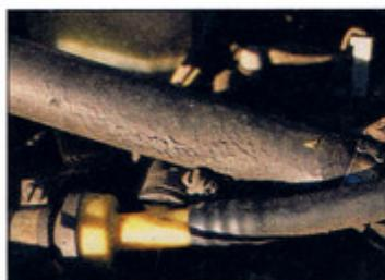
Kurbelgehäuse-Entlüftung: Dieser Schlauch ist schon arg porös
