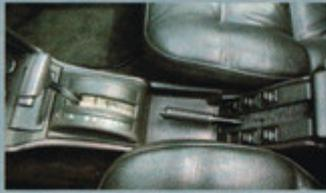
3-Gang-Getriebeautomatik mit "E-mode" – heißt, der Wagen schiebt nicht in dieser Schaltstellung im Leerlauf
