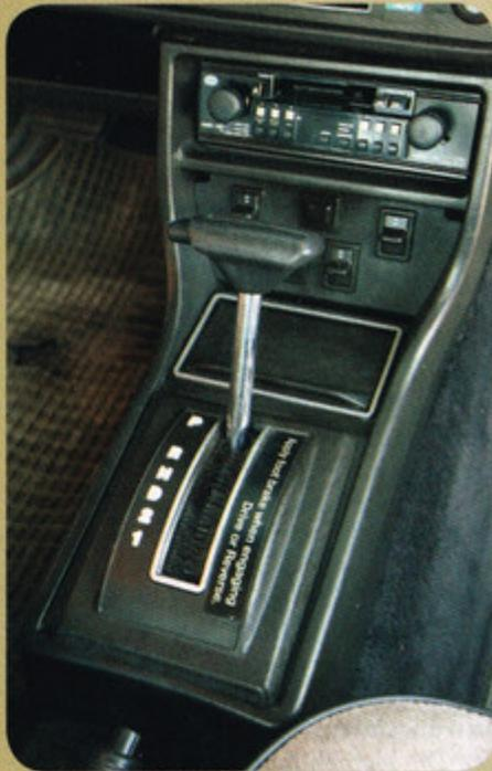
Warnhinweis am Wählhebel als Antwort auf die Audi-Beschleunigungs-Affäre in den USA. Nur bleifreies Benzin wegen früherer Abgasreinigung per Katalysator
