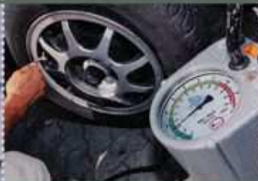
➡ Da bleibt dem Avant plötzlich die Luft weg: Zwei Reifen leiden unter schleichendem Druckverlust
