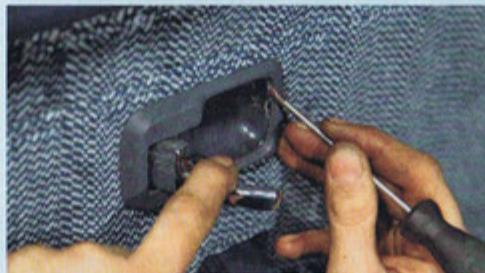
**1** Beim Ausbau der Türverkleidung gehen brü- chige Plastikteile schnell kaputt. Das ist umso ärger- licher, da sich solche Fehler vermeiden lassen
