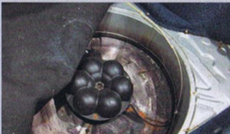
**4** Beim Audi 100 sitzt der Unterdruckspeicher in der Reserveradwanne. Bei anderen Modellen findet sich hier eine elektrische Bi-Druck-Pumpe
