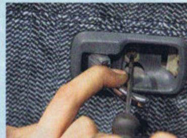
**2** Bei unserem Audi 100 taucht hinter der eingesteckten Schale noch eine Schraube auf, die zu lösen ist
