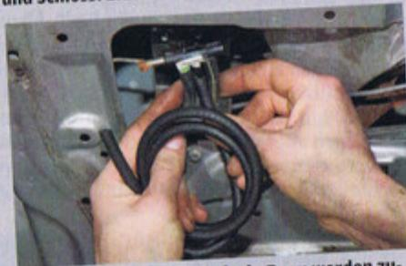
**DIE PRÜFUNG** ist einfach. Dazu werden zunächst die angeschlossenen Unterdruckleitungen gegen neue, kurze Stücke getauscht
