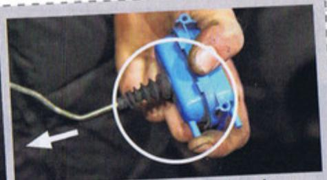
**DER SCHNELLE TEST** zeigt, ob Membran oder Gummitülle undicht sind. Wie geht's? Finger auf einen Stutzen, Gestänge herausziehen. Klappt das, liegt irgendwo eine Undichtigkeit vor
