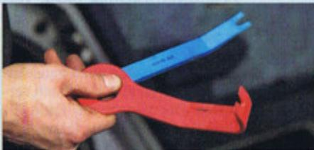
**3** Schon wieder Spezialwerkzeug: Doch diese Hebel aus glasfaserverstärktem Kunststoff sind günstig und lösen sanft alle Türverkleidungen
