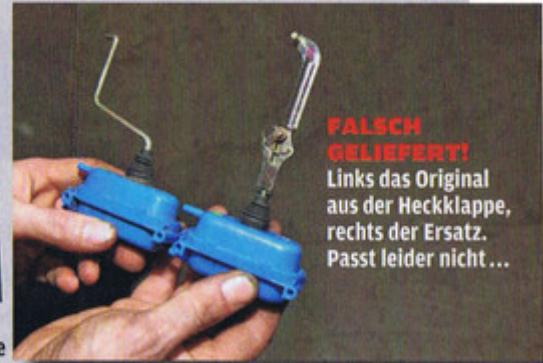
**FALSCH GELIEFERT!** Links das Original aus der Heckklappe, rechts der Ersatz. Passt leider nicht ...
