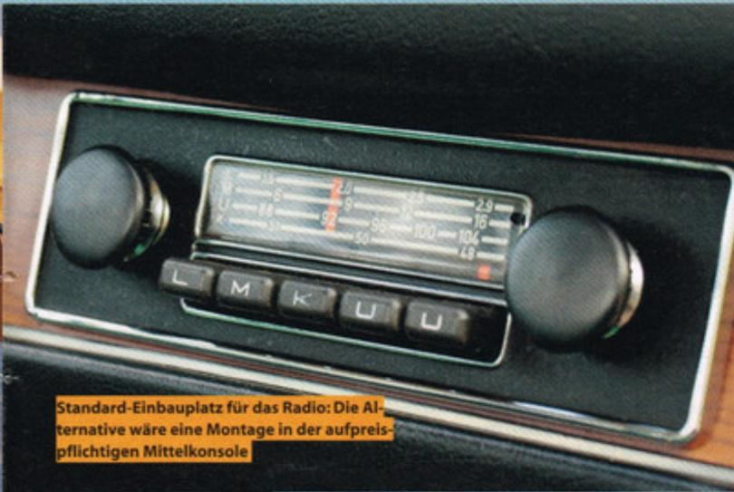
Standard-Einbauplatz für das Radio: Die Alternative wäre eine Montage in der aufpreispflichtigen Mittelkonsole
