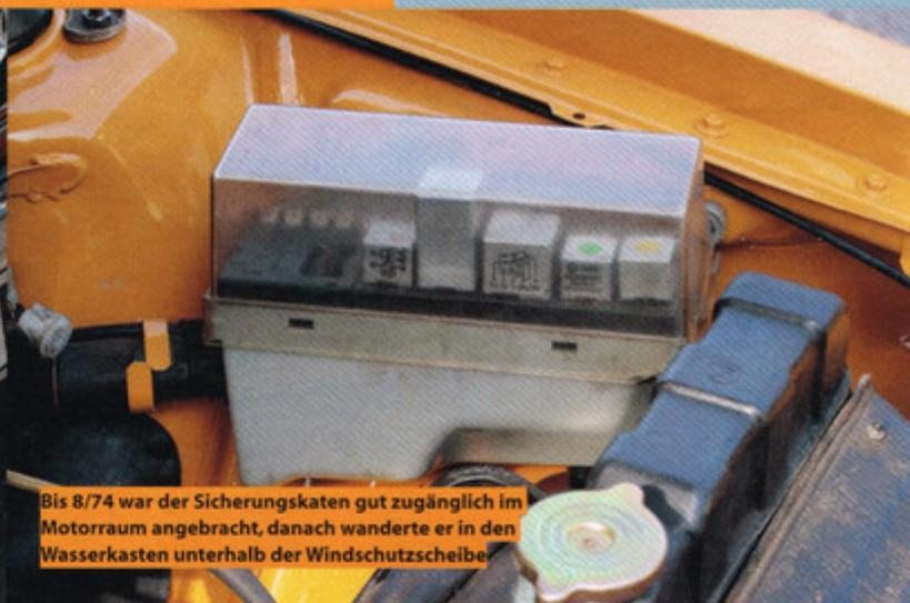
Bis 8/74 war der Sicherungskasten gut zugänglich im Motorraum angebracht, danach wanderte er in den Wasserkasten unterhalb der Windschutzscheibe
