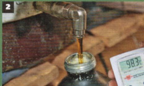
2 Durch Hitze wird alles anders. Bei knapp 100 Grad fließt das Fett wie dickes Öl in den Druckbecher
