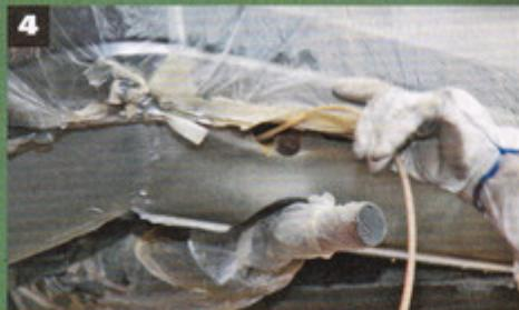
4 Der Auspuff ist gut verpackt, die Sonde spritzt das heiße Fett in die Heckschürze. Nur wer die Architektur des Modells kennt, denkt an alle Stellen
