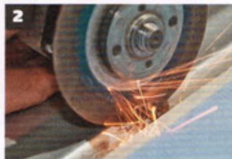
Den Rost unter der Klammer entfernt eine Schleifscheibe
