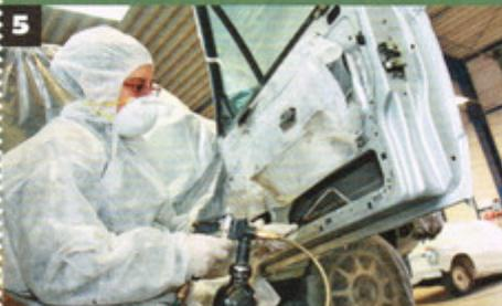
5 Etwas simpler ist es bei den Türen. Ohne Verkleidungen sind sie gut einsehbar. Wichtig: guter Schutz – das Fett klebt unangenehm
