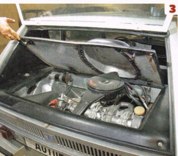
**1** Kurzer Prozess: kantiges Heck mit Klappe und extrabreiten C-Säulen **2** Hinten hat der Motor Platz, sonst keiner. Nur bei gelösten Schrauben lässt sich das Heckfenster öffnen und bietet Zugang zum TT-Triebwerk. Unter dem Buckel sitzt **3** der Luftfilter des luftgekühlten Vierzylinders. **4** Innen sieht der Autovona aus wie viele Sportwagen der 60er
