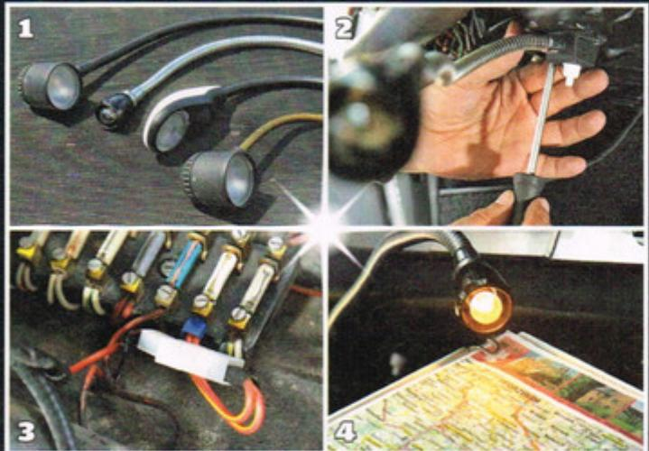
**1** Von links: Fünf-Watt-Halogenlampe zum Festeinbau (Osram, 20 Euro), klassische Rallye-Leselampe (Avanti, 45 Euro), LED-Lampe für Steckdose (Hella, 65 Euro), Osram-Modell wie links, jedoch für Steckdose **2** Einbauort: unterm Armaturenbrett **3** Anschluss im Sicherungskasten **4** Stillecht: Rallye-Lampe
